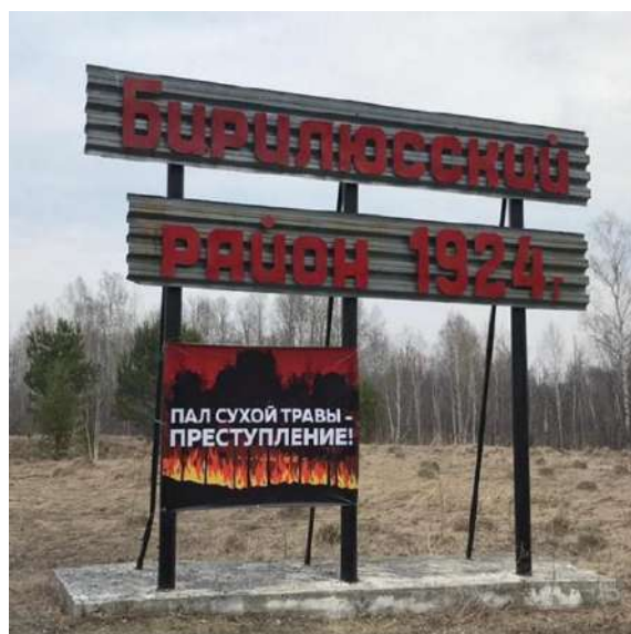
Примеры использования недопустимых материалов (баннер, искусственный газон, композитная панель, профилированный металлический лист)
